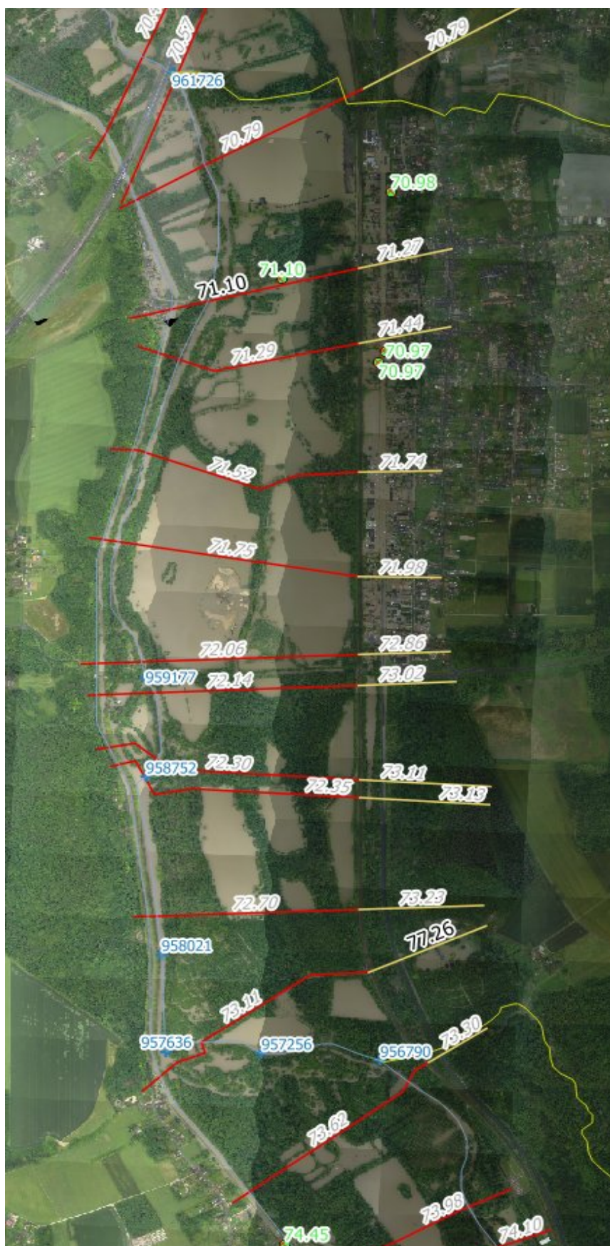
Figure 11: Profils utilisés dans le secteur du Dordives (rehausse du niveau à l'Est du remblai SNCF). Affluents du Loing en jaune (Clery au sud, Betz au nord).
